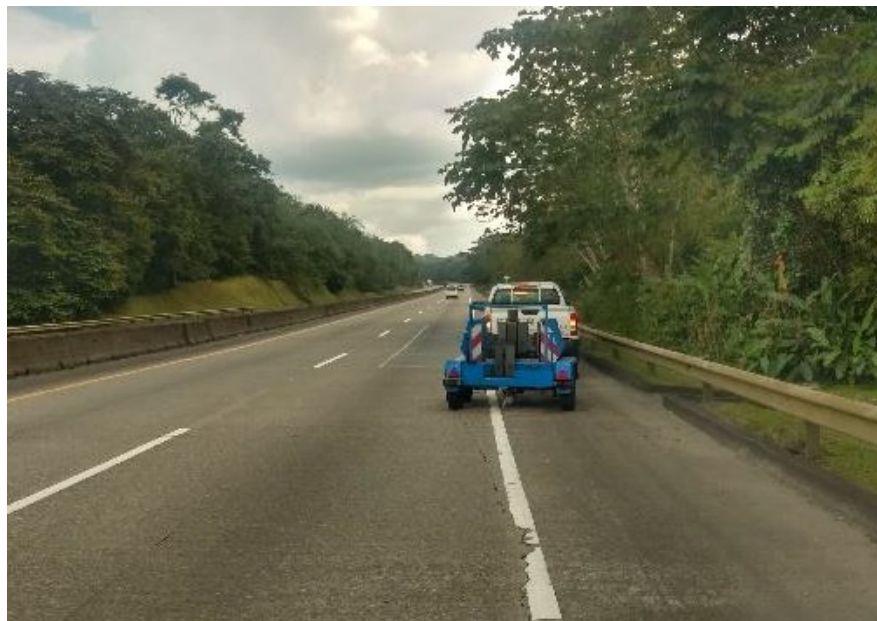
Fig. 4 Equipo Deflectómetro de Impacto HWD. Fuente: Elaboración propia
