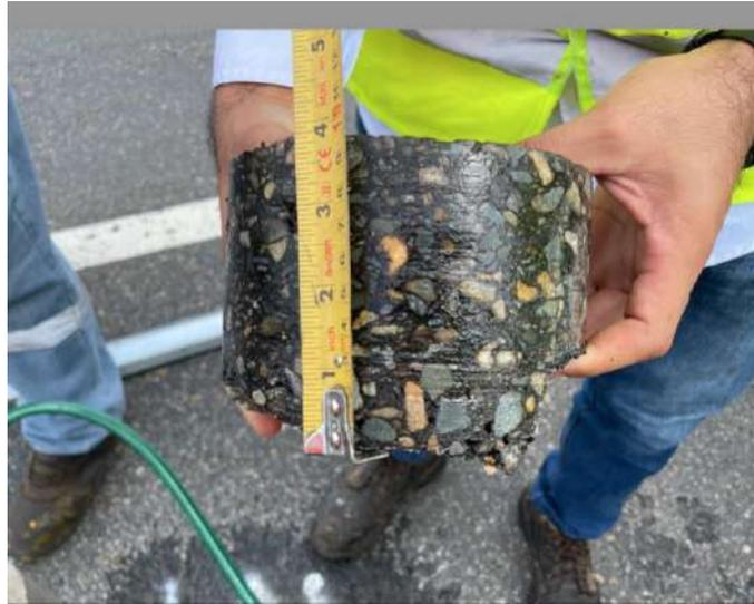
En otros sectores se logró apreciar la presencia de geotextil, entre la carpeta asfáltica y la losa de concreto, el cual mostraba una buena adherencia con la carpeta asfáltica.
