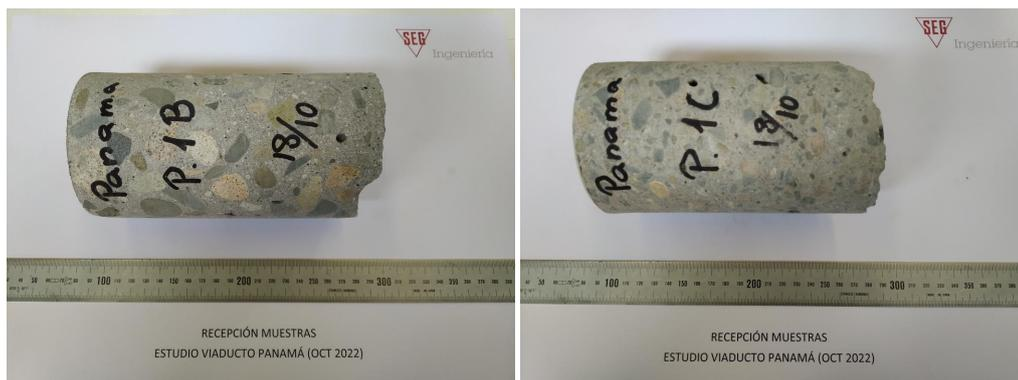
Fotos 33 y 34. Recepción de testigos de pilas
