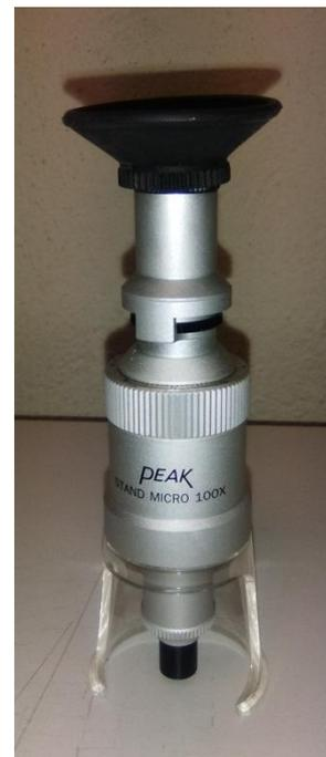
Fotos 15 y 16.- Fisurómetro 40x y Fisurómetro 100x RESPECTIVAMENTE
