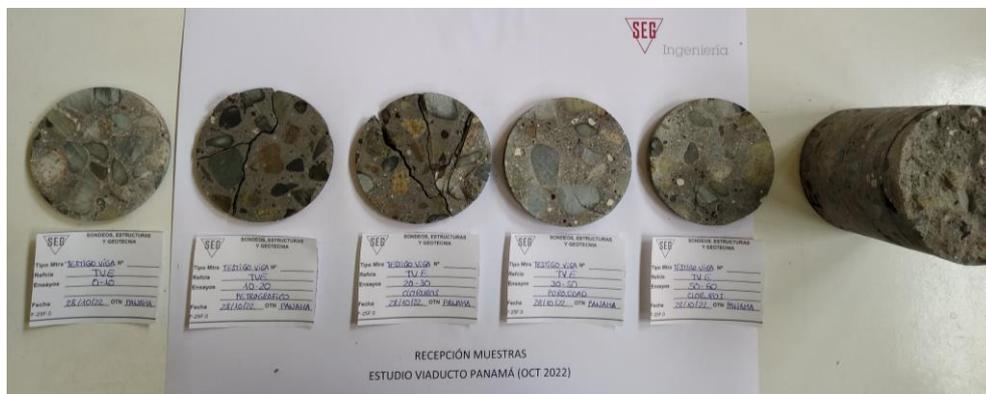
Fotos 38 y 39. Preparación de secciones para ensayos químicos
