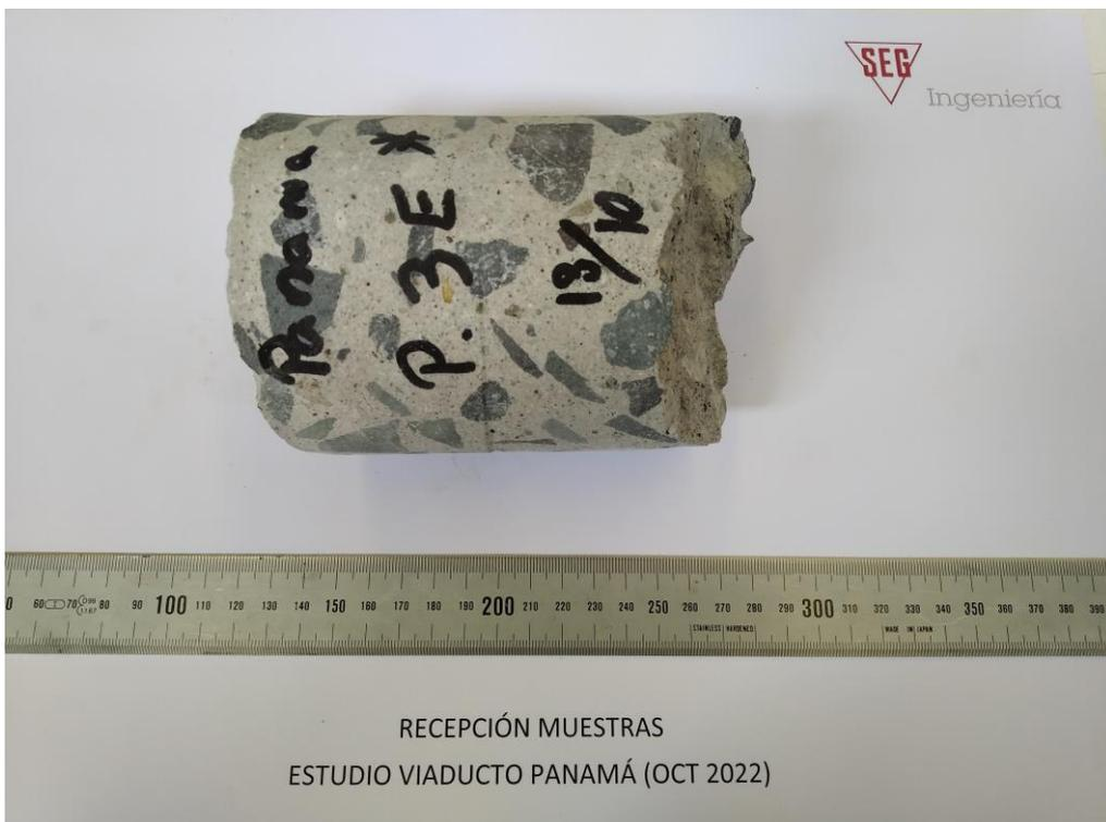
Foto 56.- Vista recepción testigo de pila 3E\*
