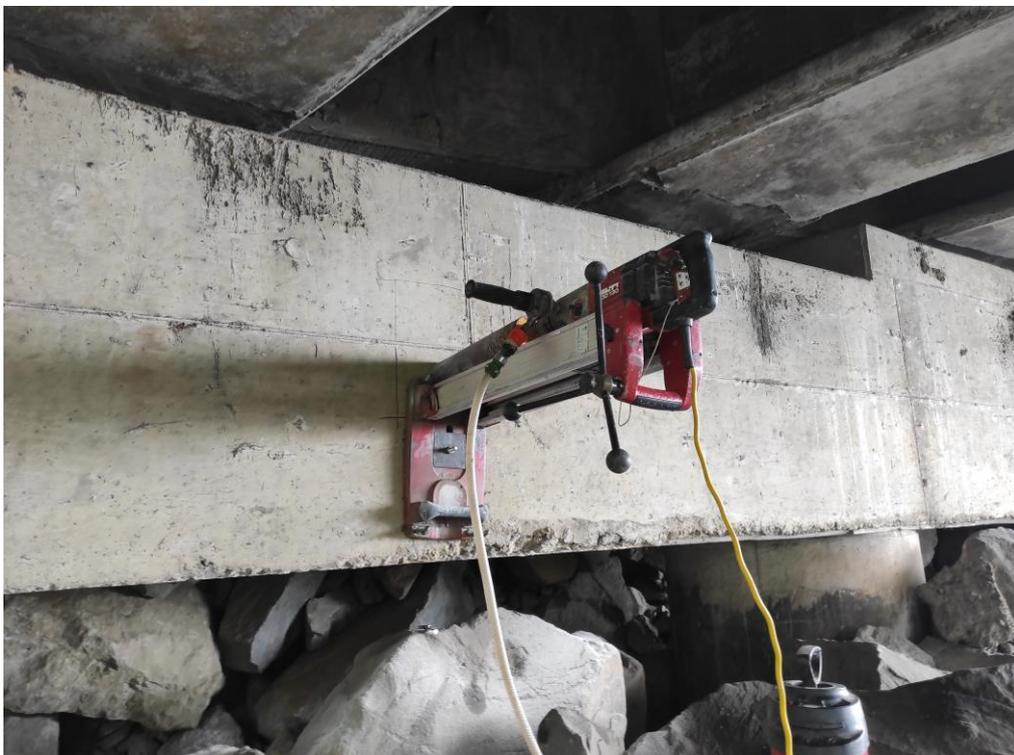
Foto 46.- Vista detalle extracción de testigo en viga de asiento A
