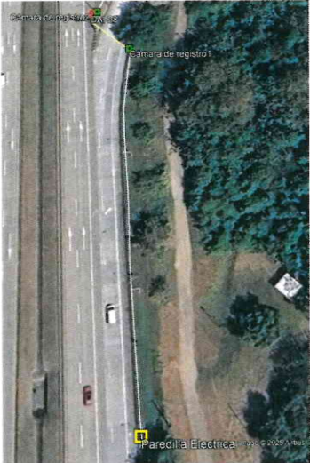
Vista desde Earth del vigaducto 1 (línea color blanca), dirección de perforación (línea color amarilla) cámaras de registro #1 y #2, paredilla eléctrica y DAI-28.
