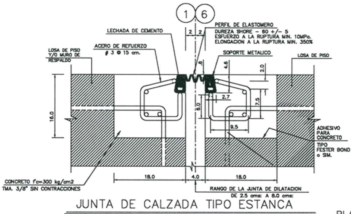
Esquema de instalación de junta original
