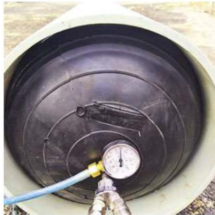
Ilustración 4. Ejemplo de Obturador de tubería.
