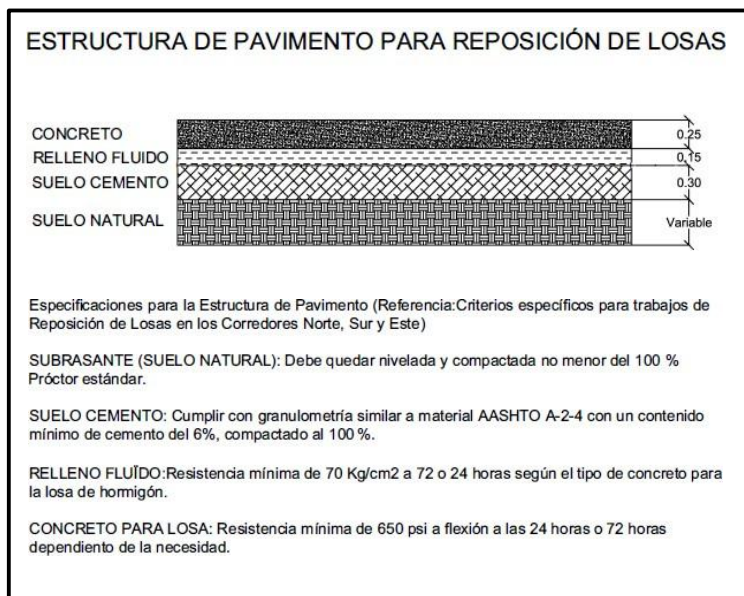
Ilustración 3. Estructura de pavimento para reposición de losas.
